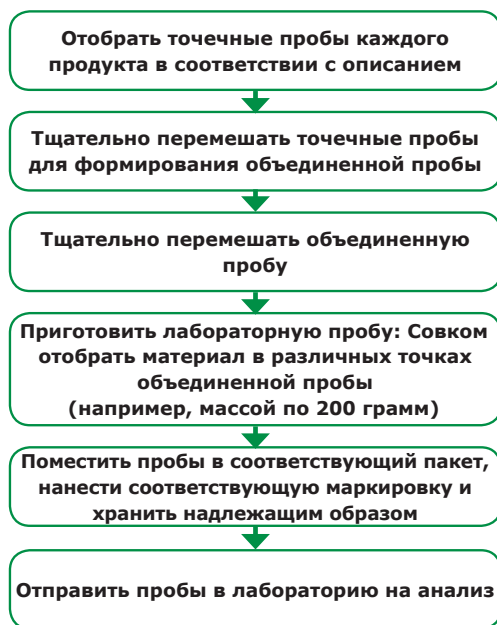
Рисунок 7. Этапы успешной процедуры отбора проб.
