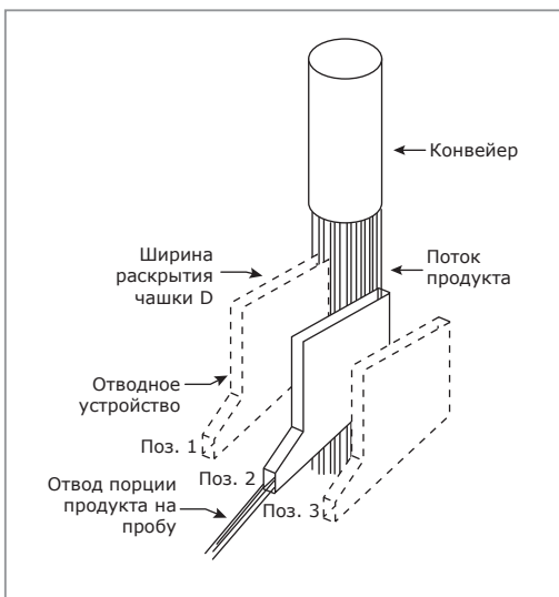
Рисунок 6. Поперечный пробоотборник перемещается с постоянной скоростью, проходя через весь поток продукта.
