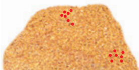
Рисунок 12. Отбор проб из зерновой насыпи. Красный x показывает место, где должна отбираться проба.
